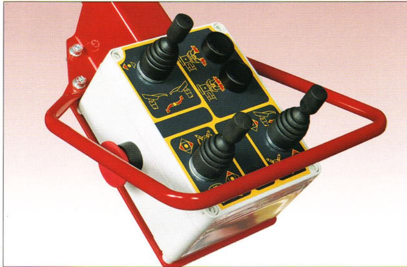
**I** Tutte le operazioni sono comandate idraulicamente tramite un ergonomico quadro comandi disposto su di un esclusivo braccio snodato. La disposizione logica dei comandi evita eventuali pericolosi errori da parte dell'operatore.
