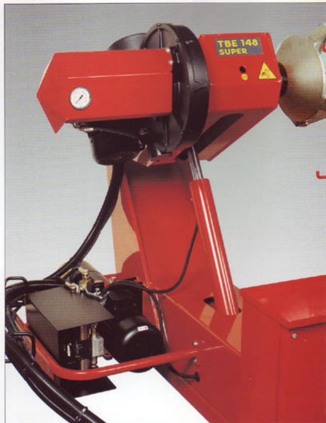
**I** L'apparecchiatura è dotata di una valvola di non ritorno che evita la chiusura accidentale della morsa in caso di mancanza di pressione.
