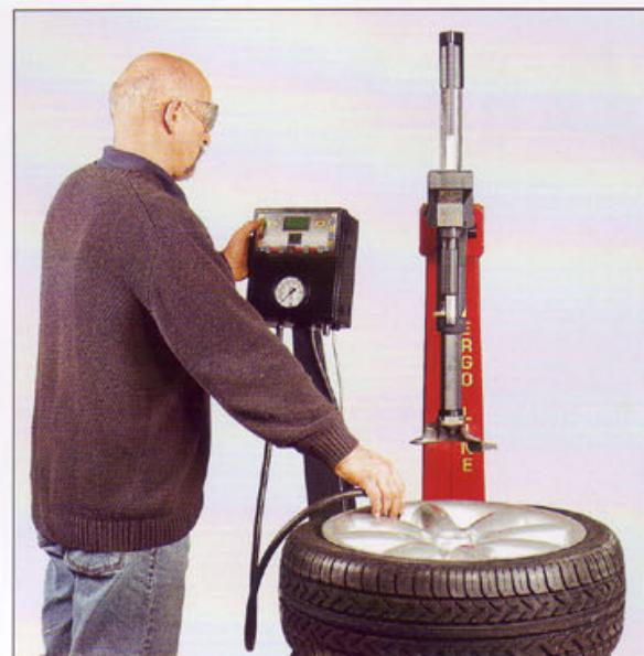
**I** Lo speciale dispositivo di sgancio rapido, disponibile a richiesta, permette di intercambiare i vari tipi di utensili (in plastica, in acciaio, moto e scooter) in tempi brevissimi.
