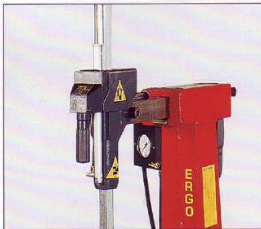
Scorrevole utensile a sezione maggiorata (60mm x 60mm) per aumentare la rigidità torsionale in fase di sforzo. La testa del piantone è di tipo brocciato, con rullino per facilitare la scorrevolezza dell'albero orizzontale ed è regolabile per mantenere prestazioni nel tempo.
