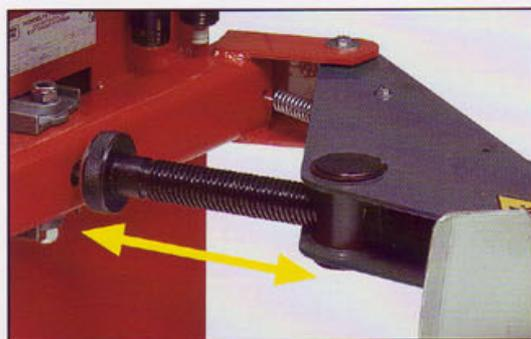
Il regolatore di corsa permette di eliminare la possibilità di schiacciamento del pneumatico.
