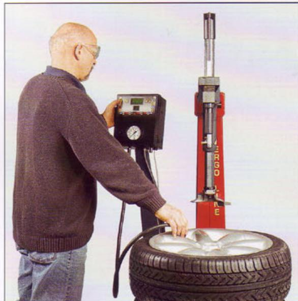
Ⓛ Lo speciale dispositivo di sgancio rapido, disponibile a richiesta, permette di intercambiare i vari tipi di utensili (in plastica, in acciaio, moto e scooter) in tempi brevissimi.
