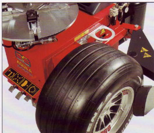
Il braccio stallonatore consente un'apertura fino a 410 mm ed è azionato da un cilindro pneumatico a doppio effetto interamente realizzato in acciaio inox che sviluppa una potenza di 15500 N sulla pala. Il profilo della pala si adatta perfettamente a qualsiasi tipo di cerchio.
